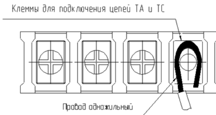
Рисунок 11 – Укладка одножильного провода
